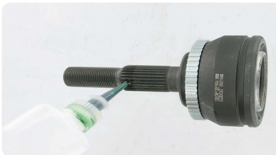
Zdjęcie 1: Nakładanie kleju montażowego
