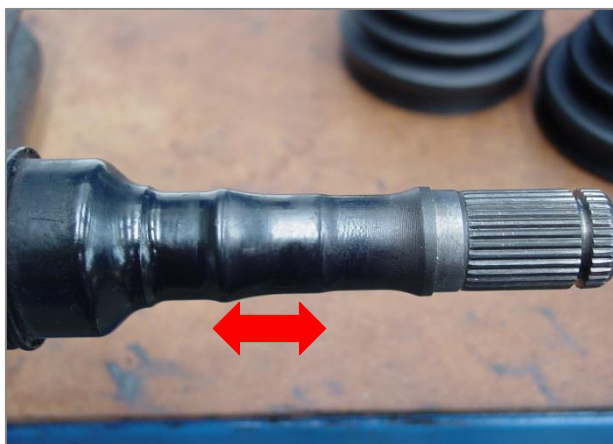
Zdj.4 – Powierzchnia do montażu osłony
