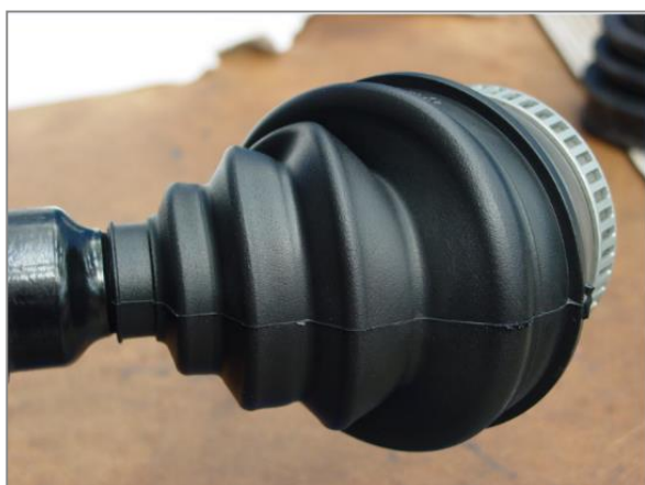
Zdj.1 – Nieprawidłowy montaż osłony
