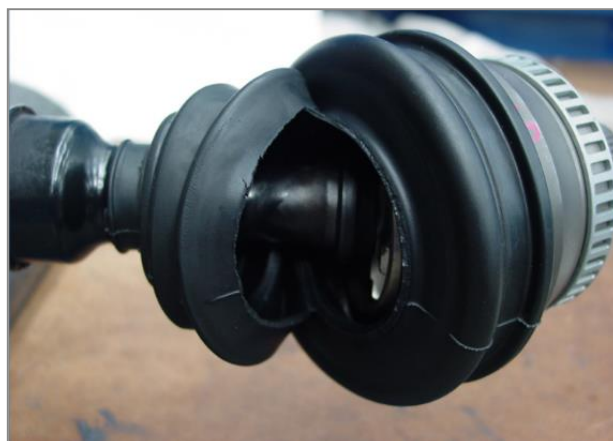
Zdj.2 – Pęknięcie osłony w wyniku nieprawidłowego montażu
