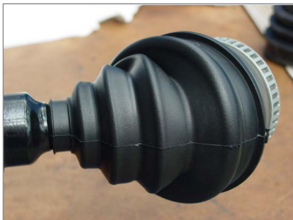
Zdj.1 – Nieprawidłowy montaż osłony
