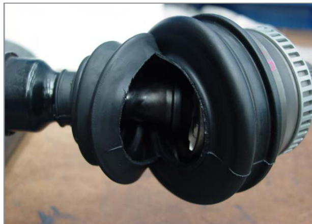
Zdj.2 – Pęknięcie osłony w wyniku nieprawidłowego montażu
