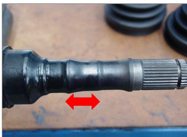
Zdj.4 – Powierzchnia do montażu osłony
