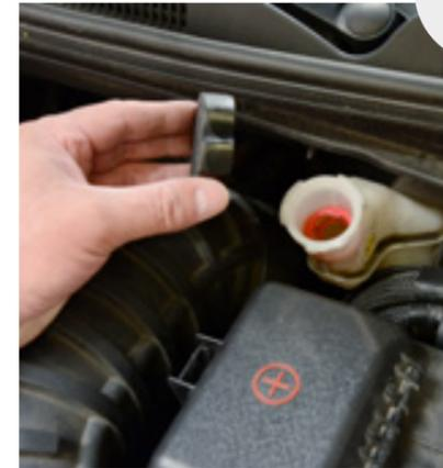
8. Bevor Sie als nächstes die Bremskolben mit einem passenden Rückstellwerkzeug zurücksetzen, sollten Sie vorher den Bremsflüssigkeitsstand überprüfen und gegebenenfalls etwas Bremsflüssigkeit absaugen. Beim Rückstellen der Kolben bitte unbedingt Herstellerhinweise beachten!
