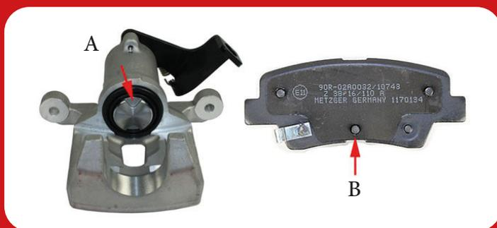
Bei einem Wechsel des Bremssattels, der Bremsseile oder den Brems Scheiben kann ein erneutes Einstellen der Feststellbremse notwendig sein.
