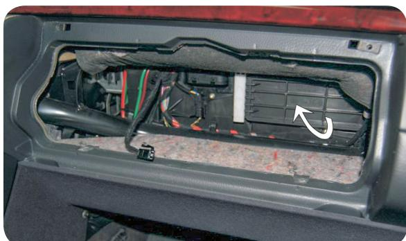
**IT** Rimuovere la copertura della camera filtrante
