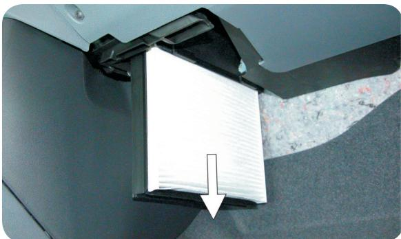
**IT** Rimuovere il filtro con il suo telaio, rimuovere il vecchio filtro dal telaio e installare il nuovo
