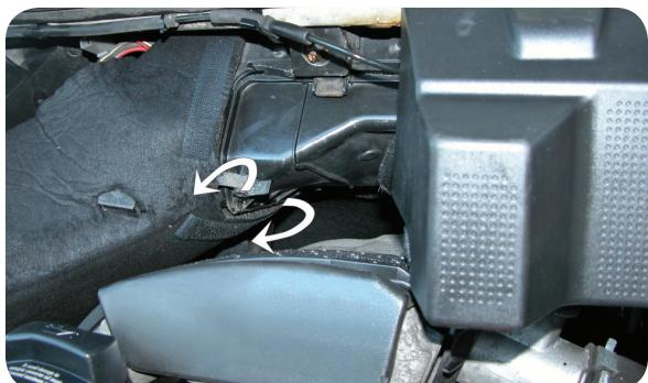
**IT** Aprire i dispositivi di blocco che trattengono l'alloggiamento del filtro
