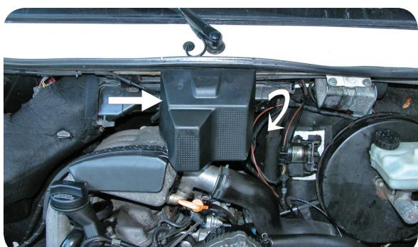
**IT** Rimuovere la copertura della camera filtrante
