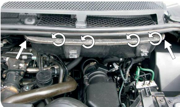
**IT** Allentare la vite. Aprire i dispositivi di blocco che trattengono l'alloggiamento del filtro
