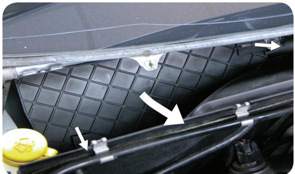
**IT** Aprire i dispositivi di blocco che trattengono l'alloggiamento del filtro.
