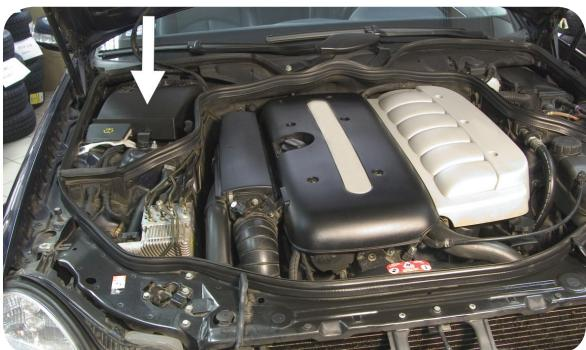
**IT** Aprire il cofano anteriore. Il filtro anti-polline si trova dietro la camera di combustione del motore
