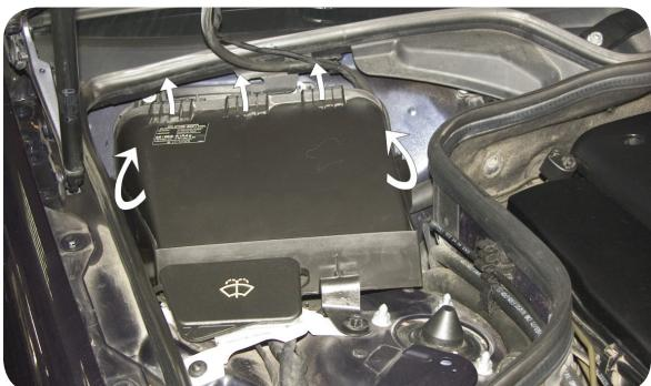
**IT** Allentare i dispositivi di blocco e rimuovere l'alloggiamento del filtro
