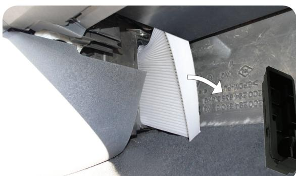
**IT** Rimuovere con delicatezza il vecchio filtro, posizionare il nuovo filtro, chiudere l'alloggiamento del filtro usando il coperchio che è inserito nel kit
