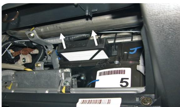
**IT** Sbloccare il filtro con il telaio dal suo alloggiamento
