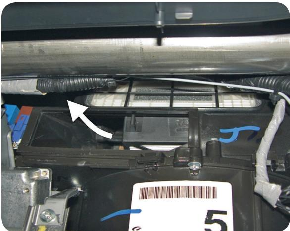
**IT** Rimuovere il vecchio filtro dall'alloggiamento, posizionare il nuovo filtro, chiudere la copertura, bloccarla con il fermo e ripetere l'operazione per l'altro filtro
