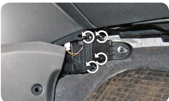
**IT** Allentare le viti che trattengono la copertura della camera filtrante
