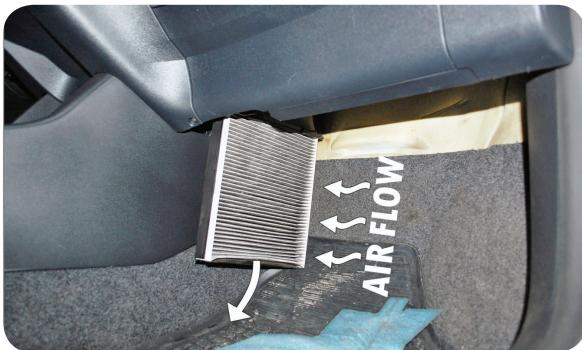
**IT** Sbloccare il filtro con il telaio dal suo alloggiamento. Il filtro anti-polline si trova dietro la camera di combustione del motore
