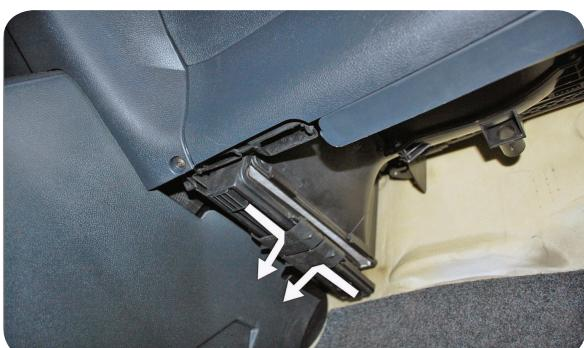
**IT** Spostare lateralmente i dispositivi di blocco che trattengono la copertura della camera filtrante
