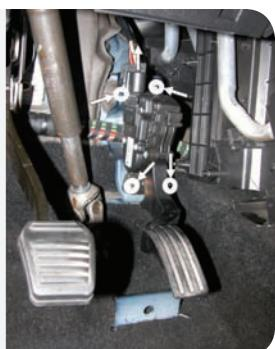
**IT** Disconnettere il circuito elettrico. Svitare le viti che fissano l'elemento mostrato nell'immagine
