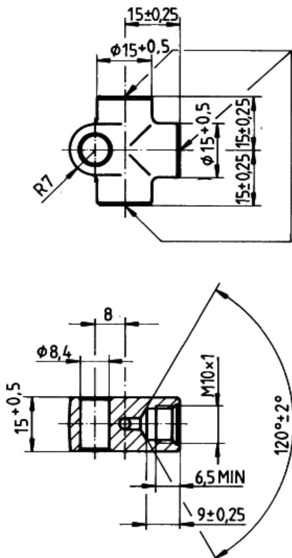
Die Leitung vom Tandemhauptzylinder (THZ) zum Bremskraftregler wird am Verteilerstück unten angeschlossen, die beiden seitlichen Abgänge werden an den beiden Eingängen am BKR (THZ1, THZ2) angeschlossen (Abb.3 - 5).
