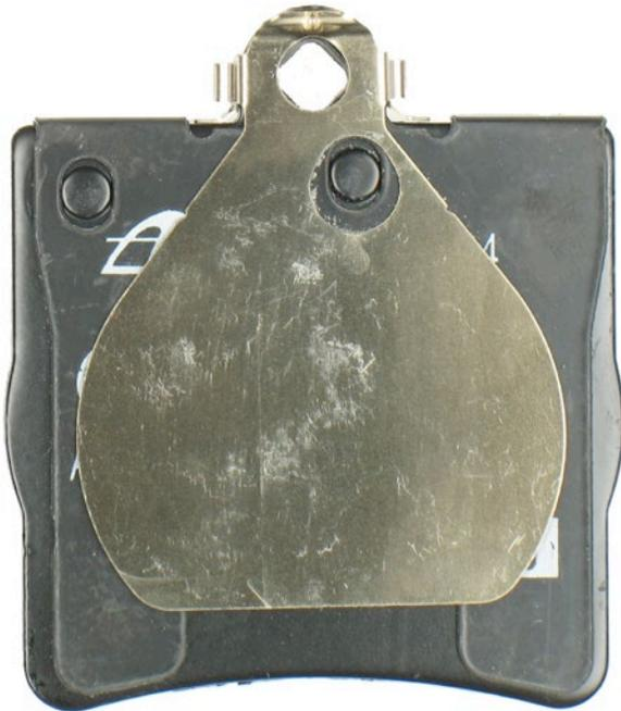
Abb. 2: Bremsbelag mit aufgesetztem Dämmblech
