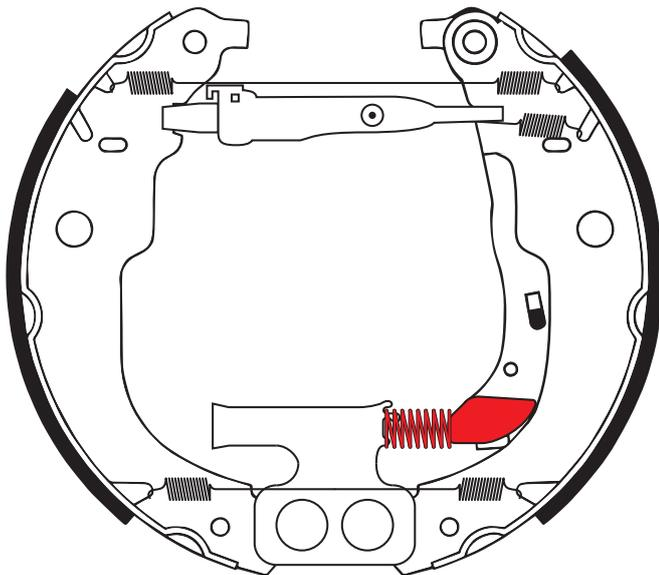
Bei o. g. Fahrzeugen befinden sich zur industriellen Vormontage werksseitig jeweils ein Halteblech und eine Feder (rot) im Bereich des Bremsbackenhebels.
