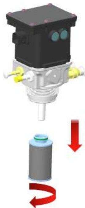
6. O Arla 32 que eventualmente flui ou escorre da unidade de suprimento deve ser limpo com um pano seco e sem fiapos. Seque a unidade de suprimento!
