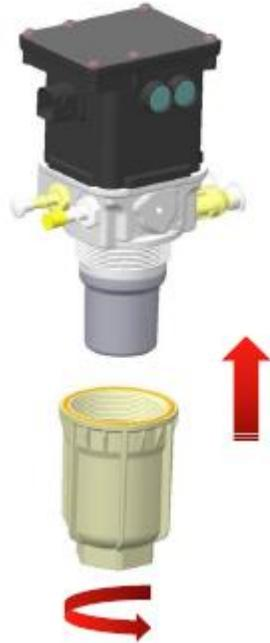
17. Aperte a carcaça do filtro com a chave de torque SW46 a  $80 \pm 5\text{Nm}$ .
