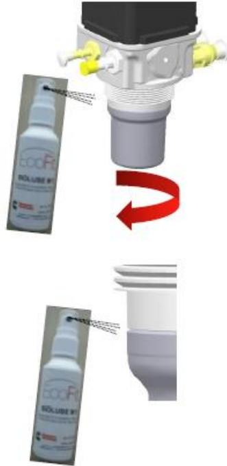
15. A rosca na carcaça da bomba precisa ser lubrificada com o spray Biolube.
