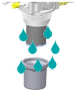
**4.** Retire a membrana de compensação de gelo da carcaça da bomba.
