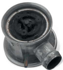
Uszkodzenie spowodowane przez skroplone spaliny
