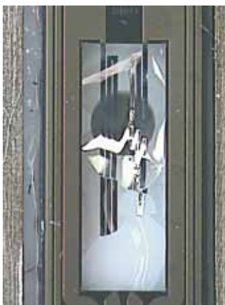
Skutki czyszczenia sprężonym powietrzem
