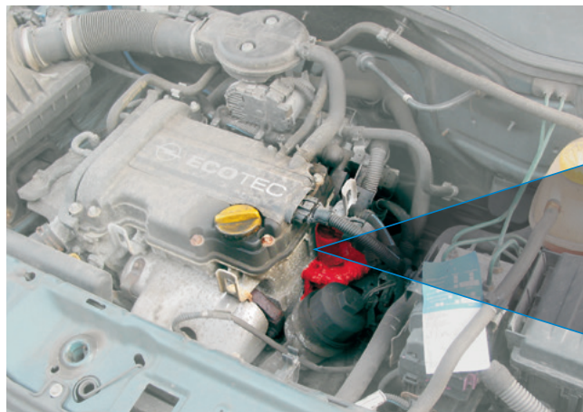
Elektryczny zawór EGR w pojeździe Opel Corsa (zaznaczony)
