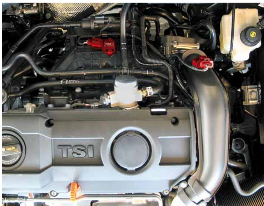
Czujnik ciśnienia kolektora dolotowego (z lewej) i czujnik ciśnienia doładowania (z prawej) w VW Golf VI (zaznaczono na czerwono)
