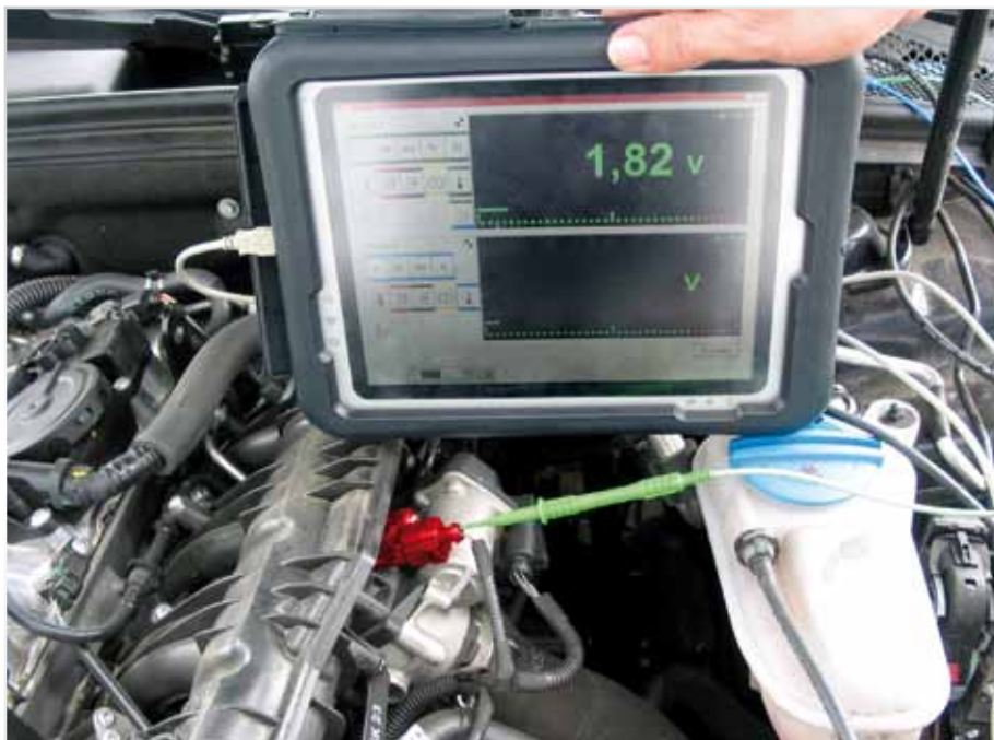
Pomiar napięcia wyjściowego na czujniku ciśnienia kolektora dolotowego (zaznaczono) w Audi A4 TFSI
