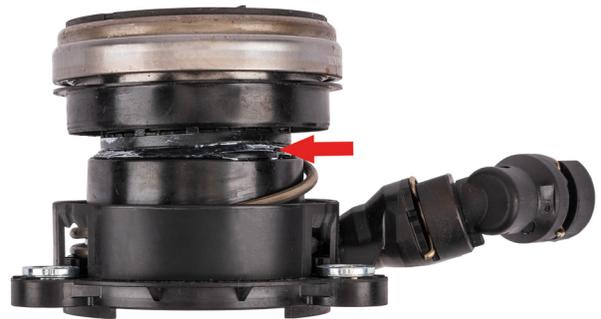
Fig. 4: Cojinete hidráulico dañado por una instalación errónea
