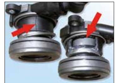
Figur 5: CSC skadet av feilaktig installasjon
