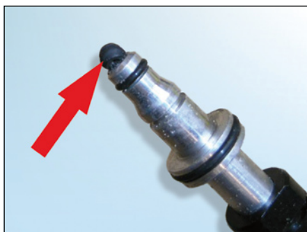
Fot. 4: Nieusunięta stara uszczelka blokuje dopływ do wysprzęglika
