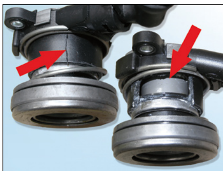
Fot. 5: Wysprzęglik zniszczony wskutek wadliwego montażu.
