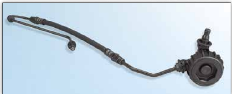
Figur 1: Hydraulisk linje med frekvensmodulator (vibrasjonshindrende enhet)
