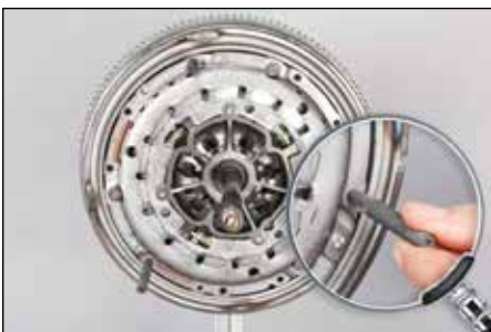
Figur 5: Drei manuelt pluggene på SAC-verktøyet inntil du kjenner lett motstand; ikke bruk verktøy
