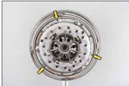
Figur 9: Skru manuelt inn de gjenværende 3 skruene og dra til med 10,5±1 Nm
