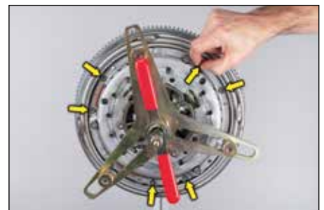
Figur 7: Sett de medfølgende skruene manuelt inn i de 6 gjengehullene og dra til med 10,5±1 Nm
