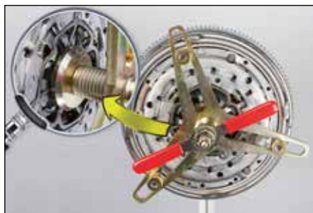
Figur 6: Sett på SAC-verktøyet og foreta forstramning av trykkplaten inntil dekkflensen hviler på LuK DMF
