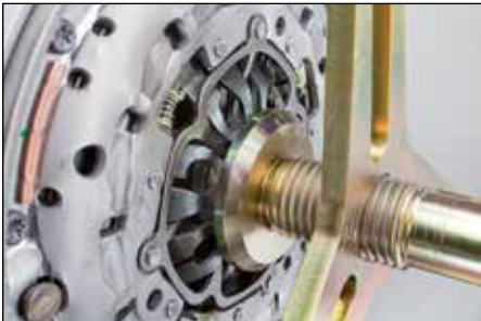
Figur 8: Frigjør membranfjæren ved å løsne SAC-verktøyspindelen og fjern verktøyet ved bruk av pluggene
