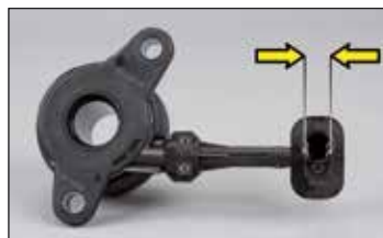
Figur 1: LuK CSC 510 0090 10 hydraulisk tilkobling 12.2 mm
