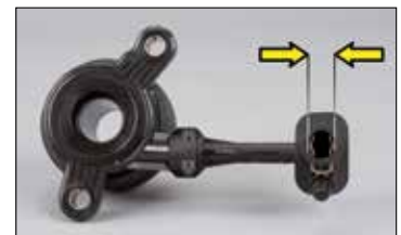
Figur 2: LuK CSC 510 0097 10 hydraulisk tilkobling 13.3 mm
