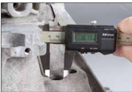
Figur 2: Hvis diameteren er mindre enn 21 mm, må disse forstørres til minst 21 mm, med en maks. på 24 mm
