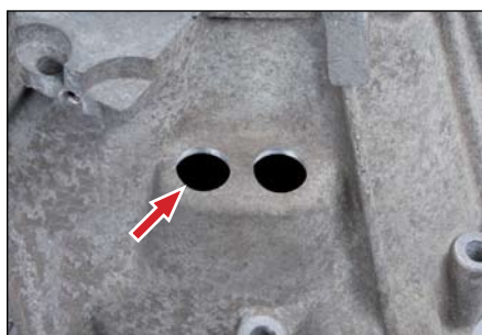
Foto 6: Stępanie krawędzi i oczyszczenie
