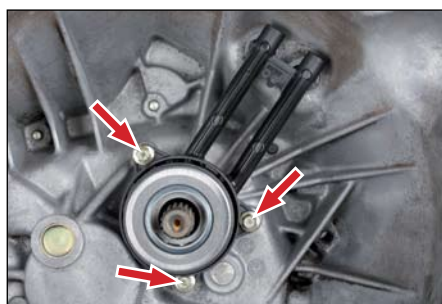
Foto 7: Montaż nowego siłownika
