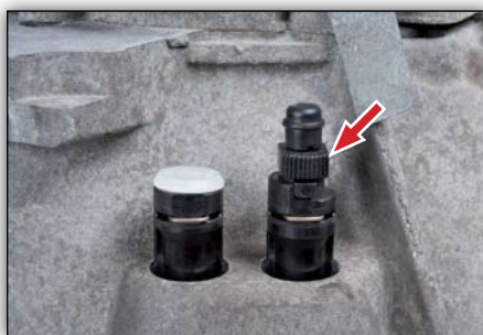
Foto 8: Odpowietrznik można odkręcić ręką lub kluczem płaskim nr 13
