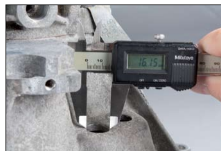
Foto 2: Jeżeli średnica otworów jest mniejsza niż 21 mm, należy je powiększyć do 21 mm lub do maksymalnie 24 mm.
