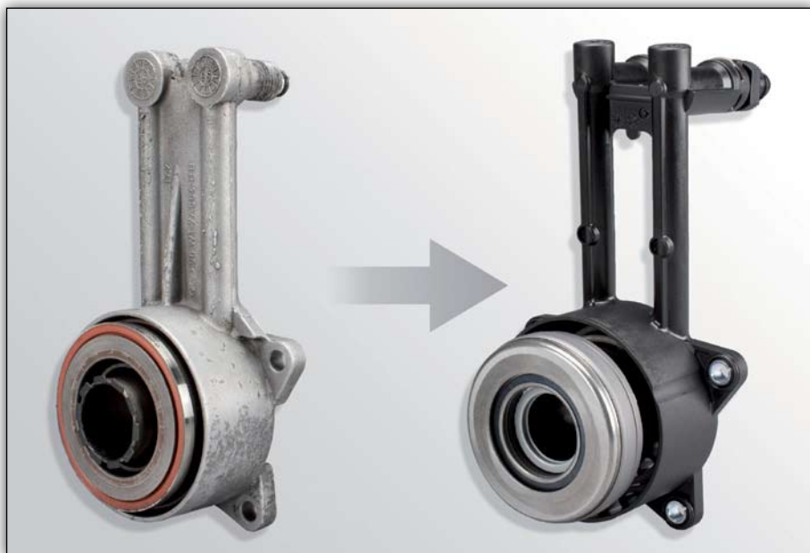
Foto 1: Zmiana z konstrukcji metalowej na konstrukcję z tworzywa sztucznego
