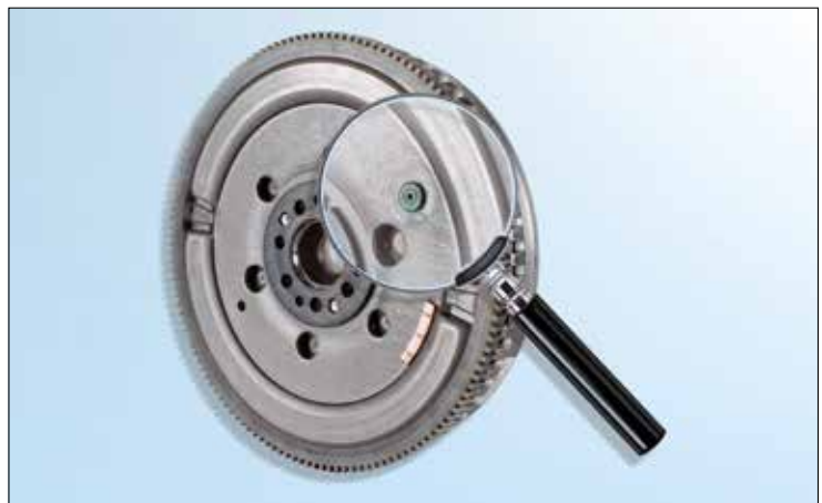
Figur 1: Transportsikringen forblir i tomassesvinghjulet
