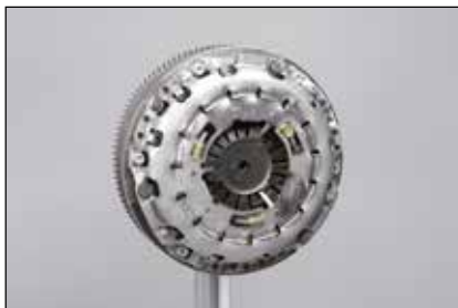
Figur 7: Fest clutchens trykkplate og stram til skruene jevnt og sekvensielt ved å bruke dreiemomentet som er opplyst av kjøretøyproduzenten.
