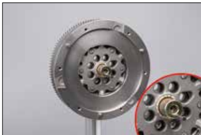
Figur 4: Monter sentreringsmuffen før montering av clutchen (se opp for den monterte skruen).
