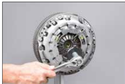
Figur 8: Skru løst låseelement med egnet verktøy og fjern det. Dette er ikke lenger nødvendig.
