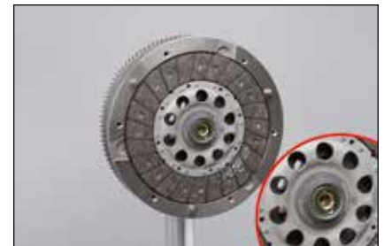
Figur 6: Fjern skruen fra sentreringsmuffen.
