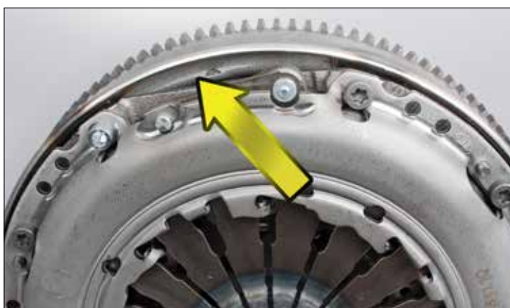
Figur 1: Materialslitasje forårsaket av en skrue som er for lang
