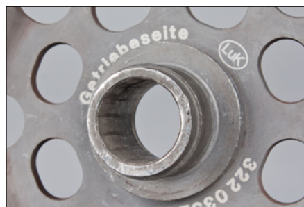
Foto 2: Uszkodzony wielowpust piasty
