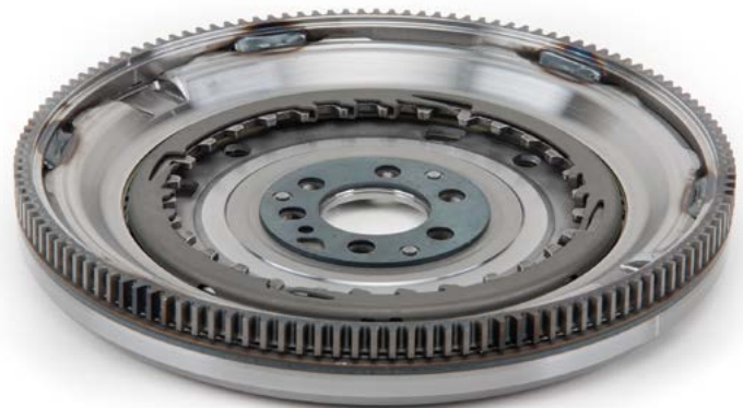
Figur 1: Antall tenner på den nye delens startkran må stemme med antall tenner på den gamle delens startkran
