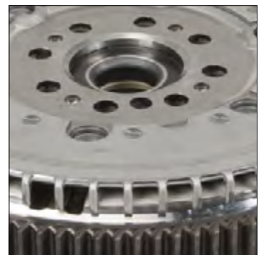
Foto 2: Nowa konstrukcja pierścienia czujnika
