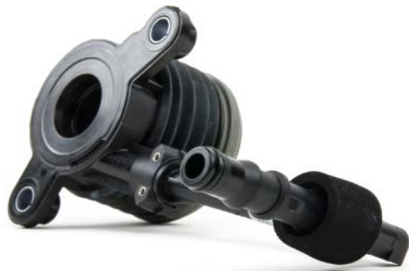
Foto 2: Centralny wysprężnik hydrauliczny z dużym przyłączem
