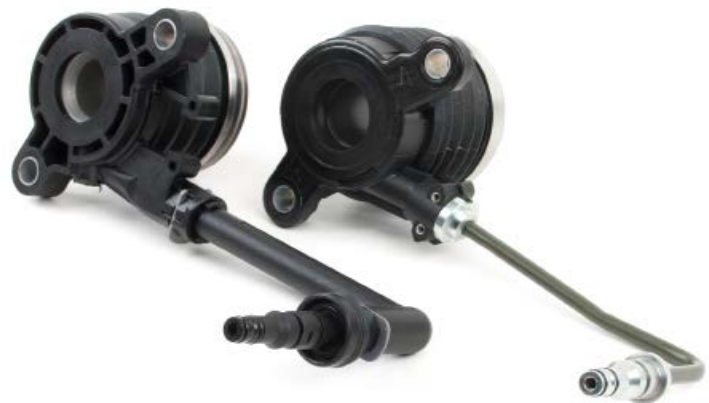
Foto 1: Centralne wysprężniki hydrauliczne z małymi przyłączami
