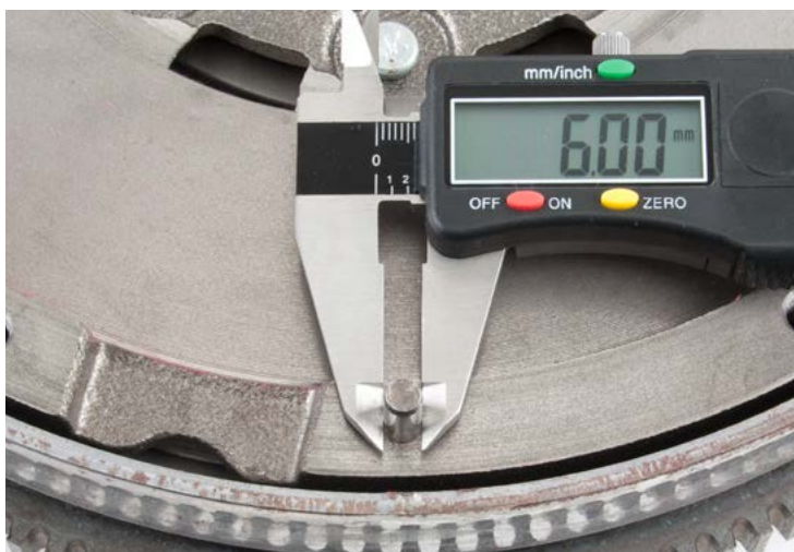
Foto 1: Pomiar średnicy kołka centrującego
