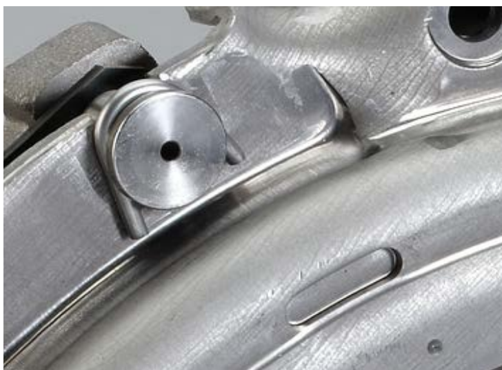
Foto 2: Blokady transportowe zainstalowane pomiędzy łbem nitu, a korpusem sprzęgła.
