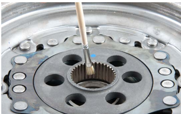
Foto 1: Niewielką ilość smaru nanieść na wielowypust wewnętrzny DKZ przy każdej jego naprawie
