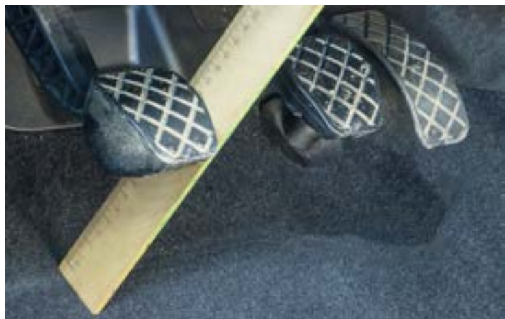
Foto 1: Po wymianie sprzęgła należy wyregulować skok jałowy
