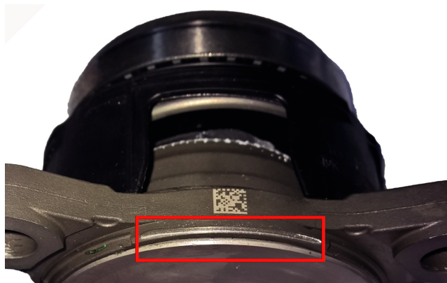
Foto 2: Uszkodzony wysprzęglik z rozwarstwionym uszczelnieniem
