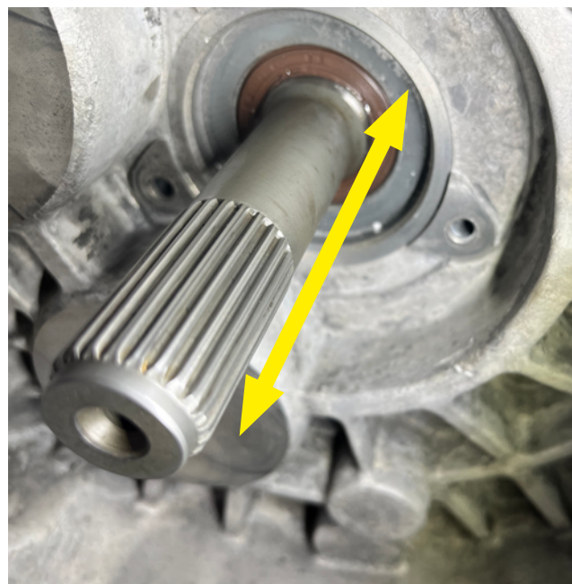
Zdjęcie 2: Luz osiowy wału wejściowego skrzyni biegów
