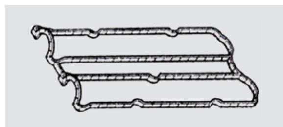
Fig. 1\_Guarnizione per coperchio valvole in plastica
