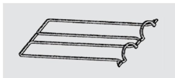
Fig. 2\_Guarnizione per coperchio valvole in alluminio,
