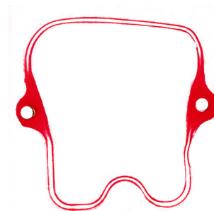
Abbildung 2 _Verpressungsbild VICTOR REINZ Dichtung 71-26428-50
