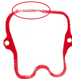
Abbildung 1 _Verpressungsbild_MAN Dichtung 70-26428-30 (OE 51.03905.0135)
