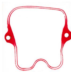
**Figura 2**\_Configuração de compressão da junta VICTOR REINZ 71-26428-50
