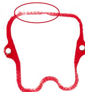
**Figura 1**\_Configuração de compressão da junta VICTOR REINZ 70-26428-30 (OE 51.03905.0135)
