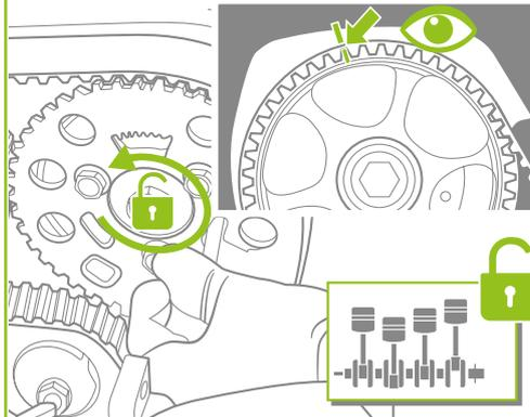
**15** Tournez à la main le vilebrequin d'environ deux tours dans le sens de fonctionnement du moteur. Il ne devrait pas y avoir de résistance. Vérifiez les marques d'alignement à nouveau. Vérifiez l'alignement axial de la courroie. Vérifiez à nouveau la tension de la courroie.
