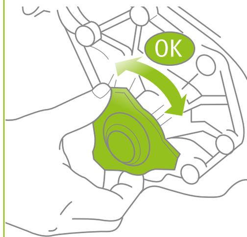
**10** Fixez les galets tendeurs et les galets enrouleurs. Serrez les vis à la main. Installez la courroie de distribution dans le sens de montage.
