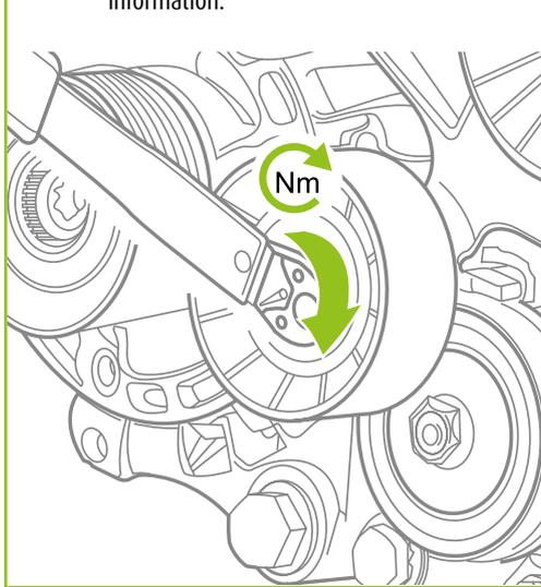
**12** Établissez la tension de la courroie à l'aide du tendeur (automatique ou procédure manuelle).
