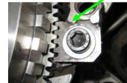
Blockieren sie das Schwungrad mit einem Spezialwerkzeug, wenn sie es mit dem Anzugsdrehmoment festziehen.
